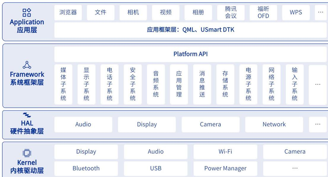
图 3-3 系统架构图
